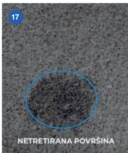
Slike 14, 15, 16 i 17: Površine tretirane sredstvima za impregnaciju ULTRACARE STAIN PROTECTOR S i W te ULTRACARE STAIN PROTECTOR W PLUS imaju manju upojnost na vodu, ulja, masnoće i tekućine općenito (test s uljem poslije 1 sata).
