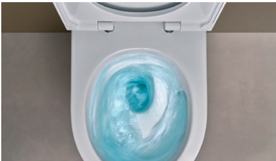
Konzolna WC školjka Geberit Acanto s TurboFlush tehnologijom ispiranja: Hidraulički optimizirana TurboFlush geometrija unutar keramike vodi vodu za ispiranje kroz unutrašnjost keramičke školjke poput snažnog vrtloga. Razvojni proces novog TurboFlusha osigurao je da je put vode precizno usklađen s Geberit ugradbenim vodokotlićima, što je stvorilo vrlo učinkovit sustav.
